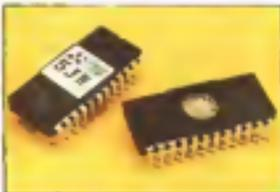
Il set di caratteri di default contenuto in MPS 801 è contenuto in una EPROM 2712. Se la si inserisce con una guida appropriata, si può così programmare da APC.
